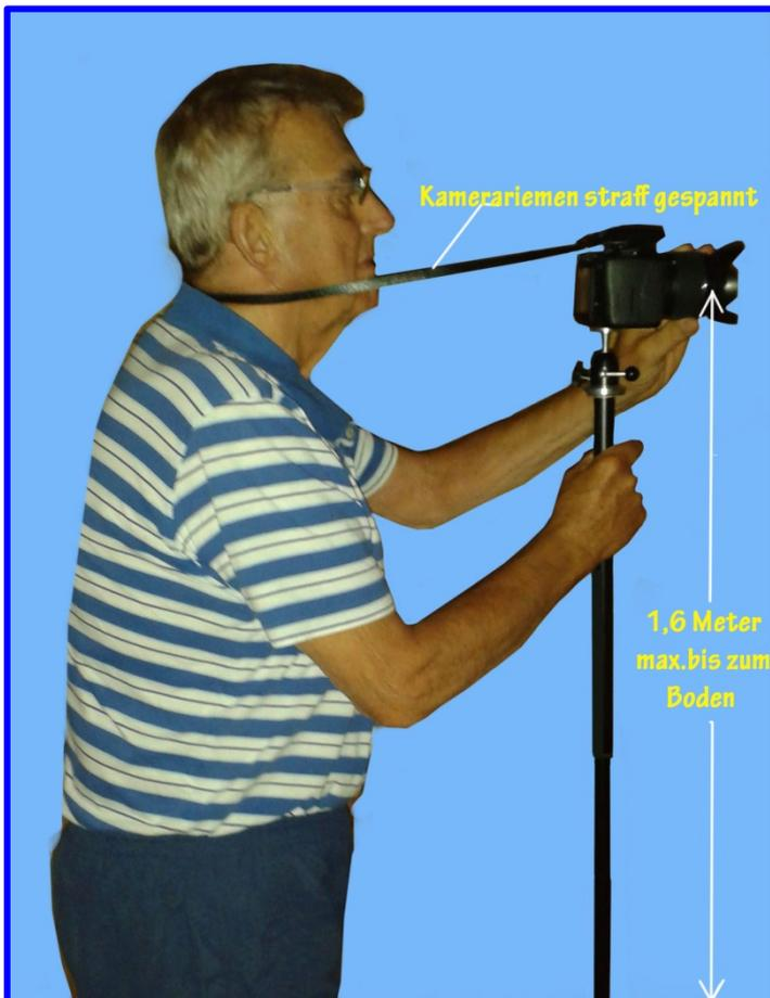
Ein ideales Hilfsmittel für möglichst verwacklungsfreie Aufnahmen. Den Kamerariemen um den Hals straff gespannt und das Einbeinstativ auf dem Fußboden abgestützt, hat man noch eine Hand frei, um bei der Videoaufnahme zu Zoomen oder mit der Kamera dem Verlauf des Geschehens durch einen Schwenk zu folgen.
