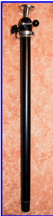
An dem Einbeinstativ, welches als Mittelkonsole in einem Dreibeinstativ herausnehmbar angeordnet ist, habe ich mir anstelle der großen Montageplatte mit einem Griff zum Schwenken lieber einen Kugelkopf montiert.
