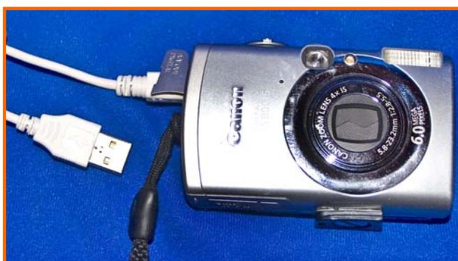
**3. Von der Kamera** über ein mitgeliefertes Kabel mit USB Stecker **in den PC** übertragen. Nachteilig hierbei ist, dass für die Übertragung der Strom vom eingebauten Akku der Kamera benötigt wird und dass das Übertragen der Bilder direkt von der Kamera deutlich länger als vom Kartenleser dauert.
